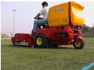
Se utiliza una maquina que posee una serie de accesorios para realizar varias funciones. Por un lado, descompacta los rellenos de granulado de caucho. De este modo, la superficie mantiene las características técnicas y biomecánicas adecuadas.
